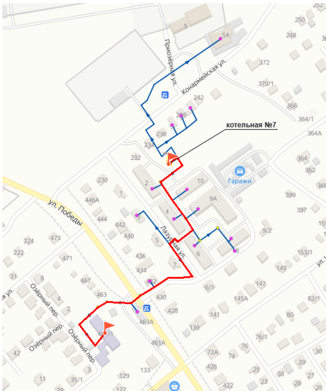
Рисунок 10 – Схема аварийного отключения тепловой сети источника №7, ул. Лазурная, 2А
